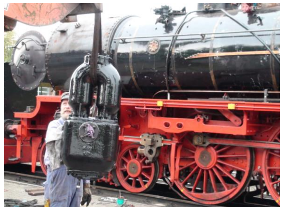
Anbau der Speisepumpe
